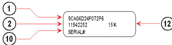
b) Etiqueta de identificação acima da HMI
